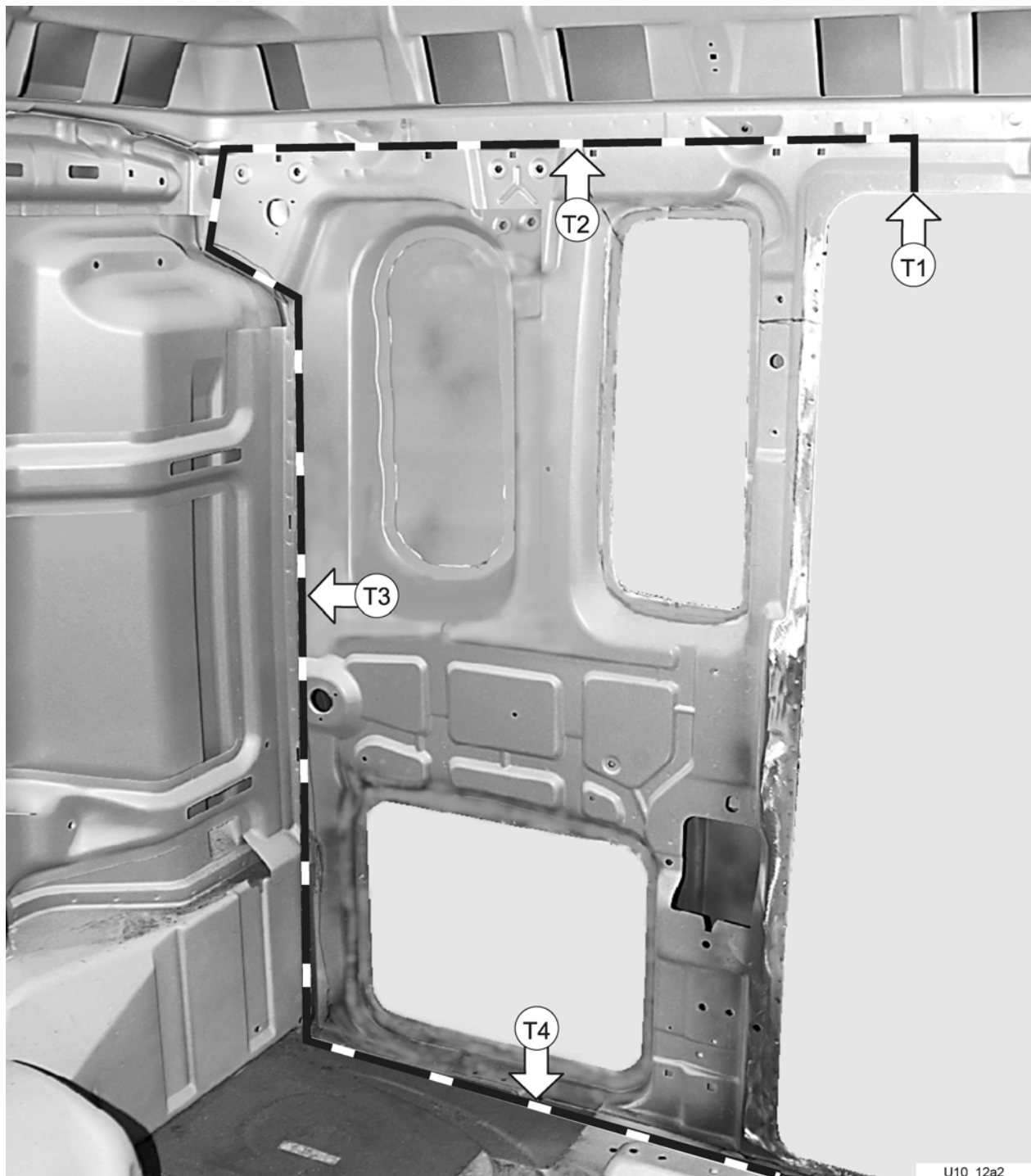
(T1-T4) Corte de separação na chapa interna do painel lateral
